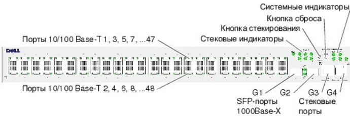
На передней панели расположены 48 портов RJ-45 с порядковыми номерами от 1 до 48. Порты, расположенные в верхнем ряду, обозначены нечетными номерами 1-47, находящиеся в нижнем - четными 2-48. Кроме того, на передней панели находятся оптоволоконные порты G1 - G2 и порты с медными разъемами G3 - G4. Порты G3 - G4 можно использовать либо в качестве стековых портов, либо для передачи трафика, если устройство работает в автономном режиме.
