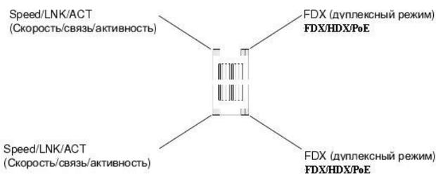
Порт RJ-45 100 Base-T на коммутаторах PowerConnect 3424 /P и PowerConnect 3448/P имеет два индикатора с обозначением LNK/ACT.
