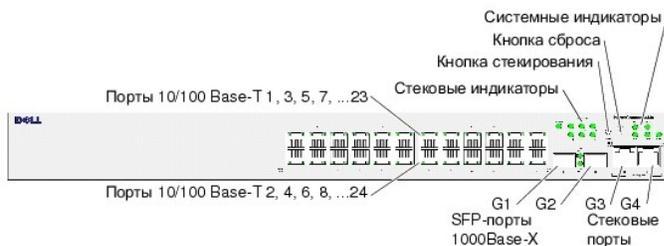
На передней панели расположены 24 порта RJ-45 с порядковыми номерами от 1 до 25. Порты, расположенные в верхнем ряду, обозначены нечетными номерами 1-23, находящиеся в нижнем - четными 2-24. Кроме того, на передней панели находятся оптоволоконные порты G1 - G2 и порты с медными разъемами G3- G4. Порты G3 - G4 можно использовать либо в качестве стековых портов, либо для передачи трафика, если устройство работает в автономном режиме.
